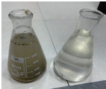
（写真左）下水処理前の下水、（写真右）処理水
