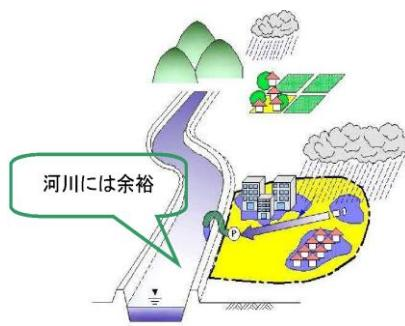
シナリオ②：下水道の雨水排水能力以下の降雨であるが、河川へ放流できないことによる浸水
