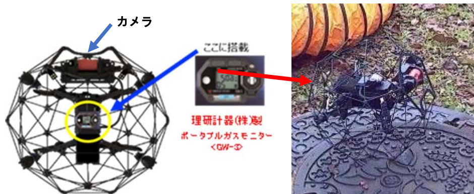
図-3 ガス検知器搭載の ELIOS2
